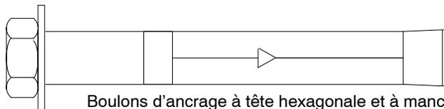
Boulons d'ancrage à tête hexagonale et à manchon 5/16-18 x 3,00
