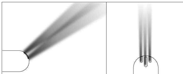
Рис. 8-3 Продольная плоскостная форсунка с углом распыления 45°
