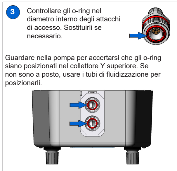
Figura 10 Assistenza del tubo di fluidizzazione
