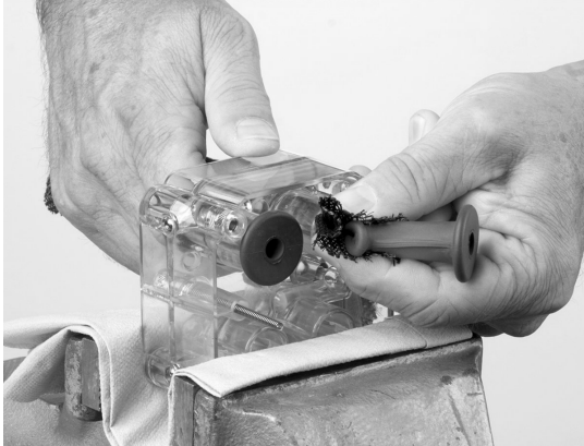
Düz esnek valf Yukarı flanşının sıkıştırılması
