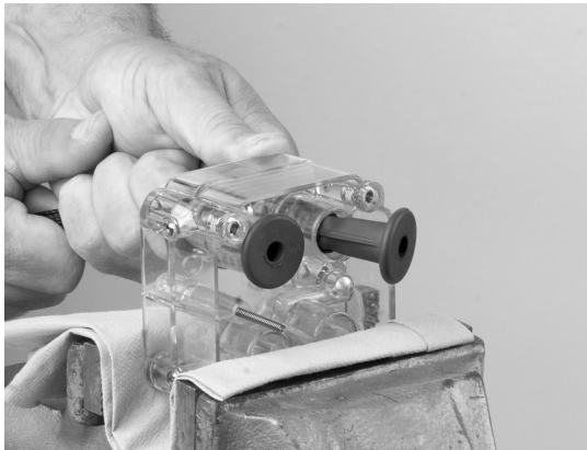
Esnek valfin valf gövdesinin içinden çekilmesi
