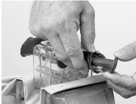
Esnek valfin pompa esnek valf aletine sokulması
