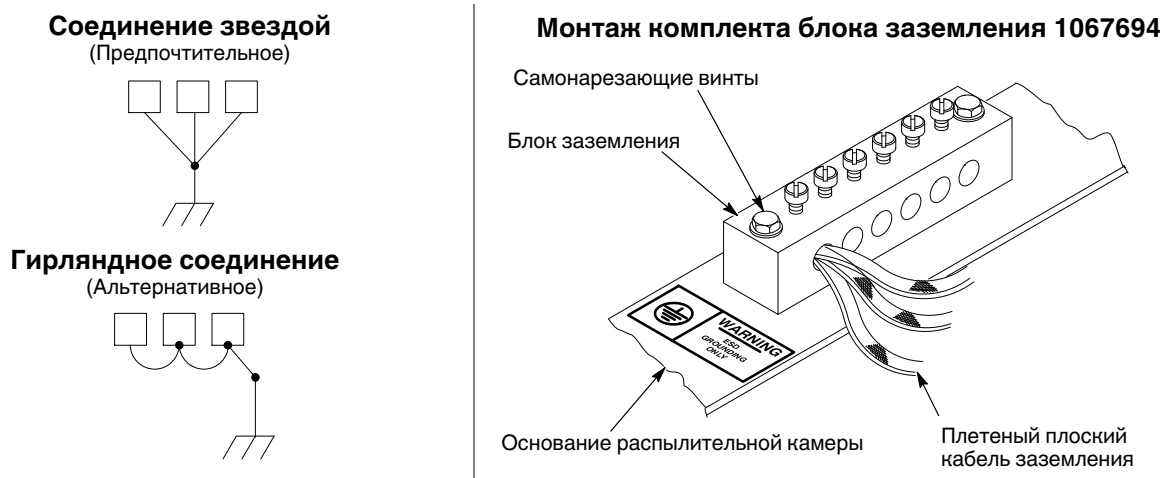
Рис. 3-5 Методы и средства заземления ESD
