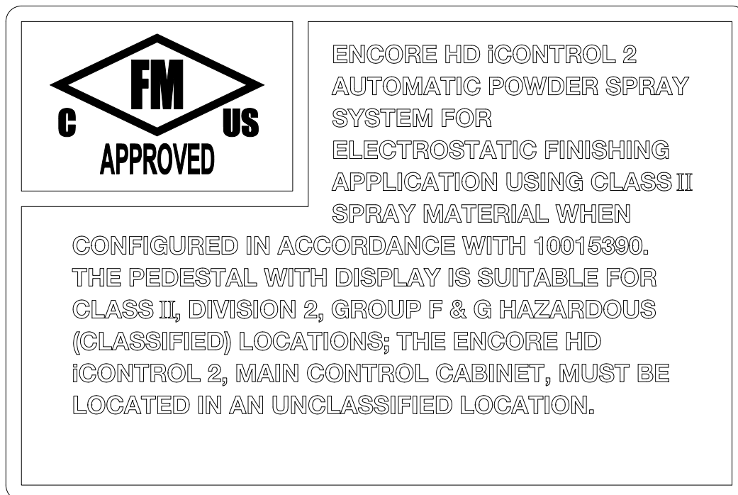
Рис. 2-7 Сертификационная наклейка FM (на главном, дополнительном шкафах и на шкафу стойки)
