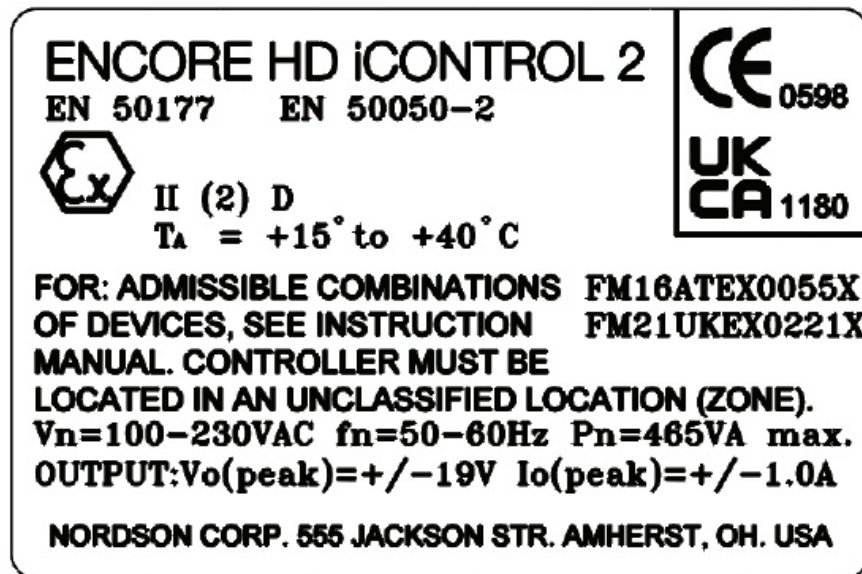
Abbildung 2-4 Schild mit-Prüfzeichen (Schaltschränke der Haupt- und Zusatzkonsole)
