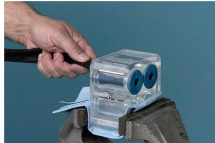
Puxe a ferramenta de inserção através do corpo da válvula, até a extremidade superior da válvula de manga flexível e a ferramenta de inserção saírem para fora da parte superior do corpo de válvulas de manga flexível.
