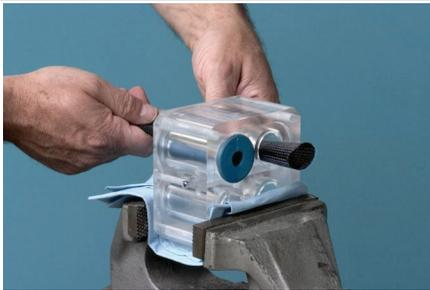
Rode o corpo de válvulas de manga flexível de modo que a extremidade superior fique voltada para si. Introduza a ferramenta de inserção de válvulas de manga flexível através do corpo de válvulas de manga flexível.
