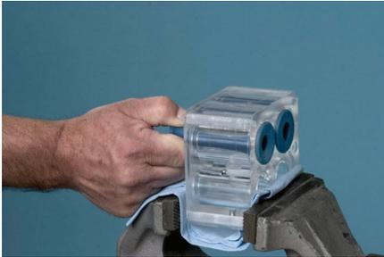
Coloque o corpo de válvulas de manga flexível, num torno de bancada com mordentes de proteção, com a extremidade inferior voltada para si. Segure e puxe a extremidade inferior da válvula de manga flexível com uma mão.
