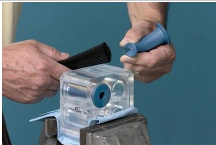
**NOTA:** Depois de ter colocado a válvula de manga flexível na ferramenta de inserção, aperte completamente a flange da extremidade superior da válvula.
