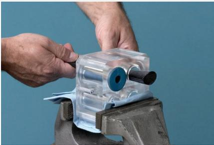
Das Gehäuse des Schlauchquetschventils umdrehen, sodass die Oberseite zu einem selbst zeigt. Das Einsetzwerkzeug für Schlauchquetschventile in das Schlauchquetschventilgehäuse stecken.
