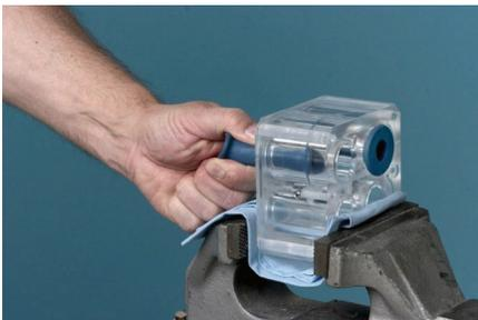
Fest am Schlauchquetschventil ziehen, bis es aus seinem Gehäuse herauskommt.
