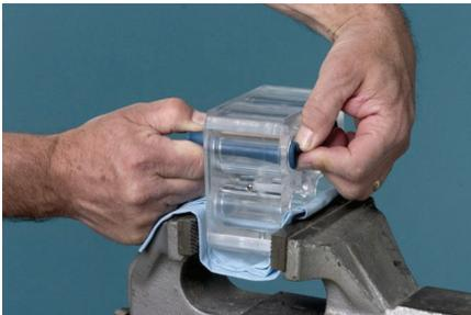
Mit der anderen Hand den Flansch am gegenüberliegenden Ende des Schlauchquetschventils zusammendrücken.
