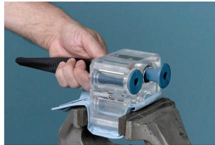
Das mit UP markierte Ende des Flansches weiterhin zusammengedrückt halten und am Einsetzwerkzeug ziehen.
