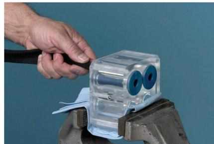
Das Einsetzwerkzeug durch das Ventilgehäuse ziehen, bis das mit UP markierte Ende des Schlauchquetschventils und das Einsetzwerkzeug aus dem oberen Ende des Schlauchquetschventilgehäuses herauskommen.
