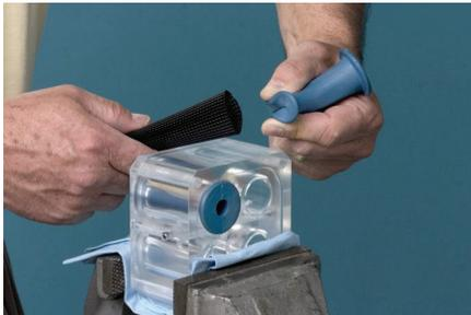
**HINWEIS:** Das Schlauchquetschventil in das Einsetzwerkzeug einlegen und den Flansch am mit UP markierten Ende des Ventils zusammendrücken.
