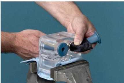
Das mit UP markierte Ende des Schlauchquetschventils in das Einsetzwerkzeug für Schlauchquetschventile stecken. Das mit UP markierte Ende des Flanschs zusammendrücken und das dünne Ende des zusammengedrückten Flanschs in das Schlauchquetschventilgehäuse stecken.
