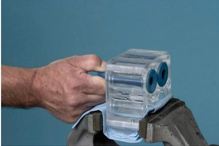
Das Gehäuse des Schlauchquetschventils in einen Schraubstock mit abgepolsterten Backen einspannen. Die Unterseite muss dabei zu einem selbst zeigen. Das untere Ende des Schlauchquetschventils mit einer Hand greifen und ziehen.
