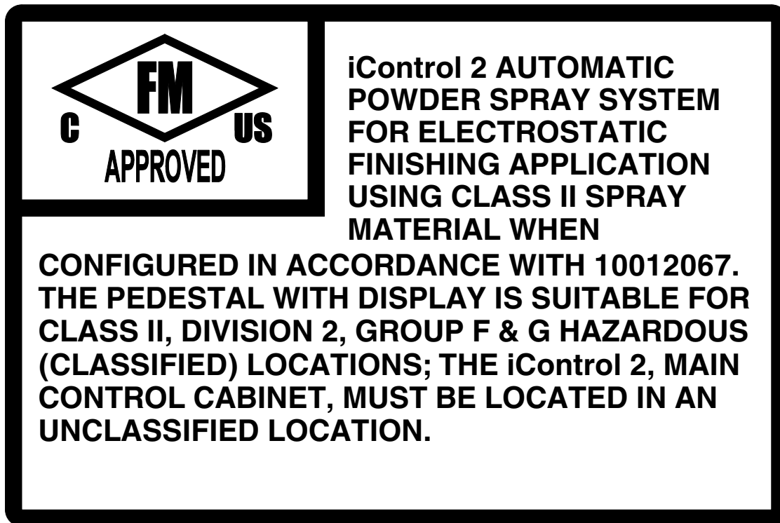
Fig. 2-8 Letreiro para aprovação FM (nos quadros elétricos principal, auxiliar e do pedestal)
