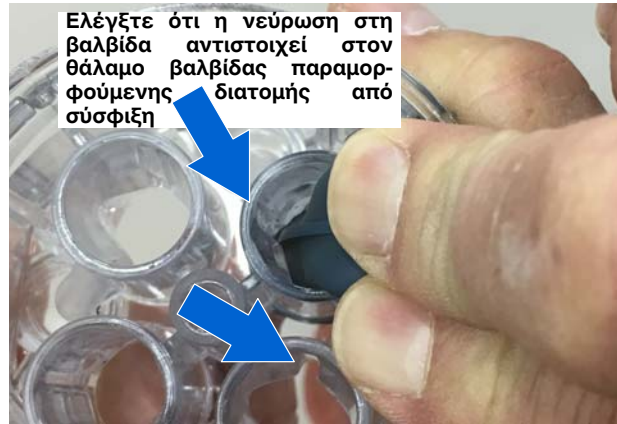
Εικόνα 33 Έλεγχος ευθυγράμμισης νεύρωσης και αυλακιού
