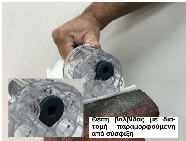
Εικόνα 31 Έλεγχος σωλήνα εισαγωγής μέσω του θαλάμου
