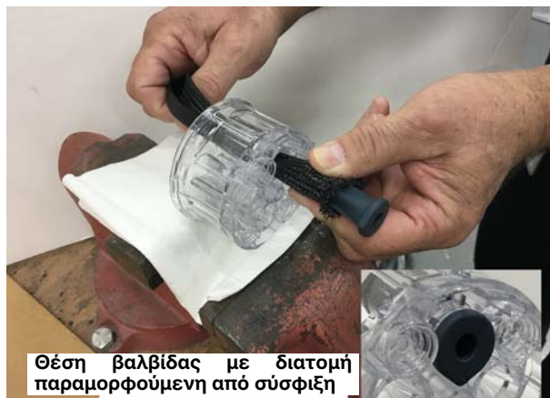
Εικόνα 30 Εισαγωγή βαλβίδας παραμορφούμενης διατομής από σύσφιξη μέσα στο εργαλείο εισαγωγής
