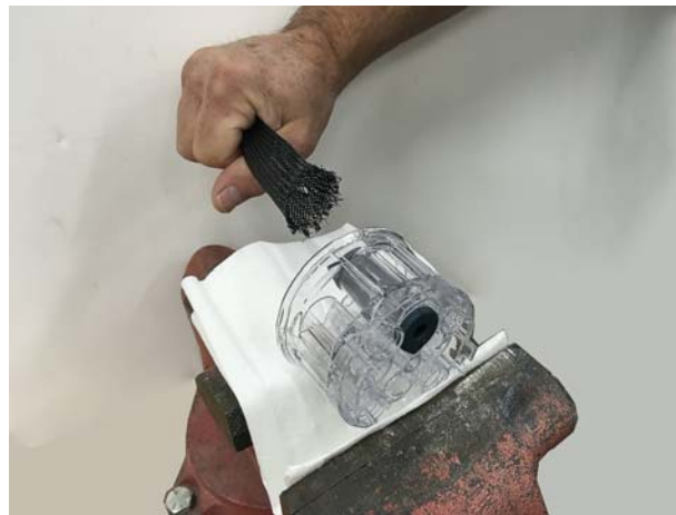
Εικόνα 32 Έλεγχος βαλβίδας παραμορφούμενης διατομής από σύσφιξη μέσα στον θάλαμο βαλβίδας
