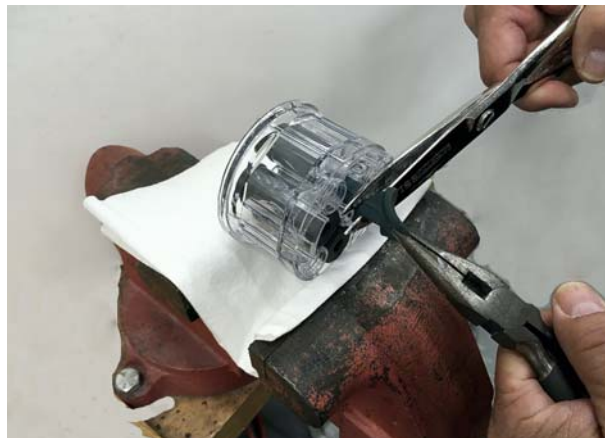
Εικόνα 29 Απομάκρυνση βαλβίδας με διατομή παραμορφούμενη από σύσφιξη
