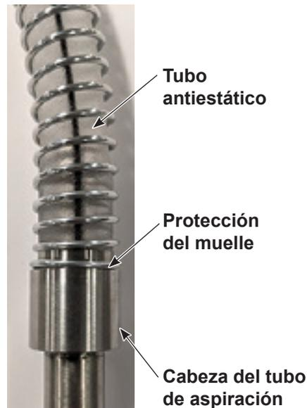
Figura 4 Montaje del tubo de aspiración con la protección de muelle
