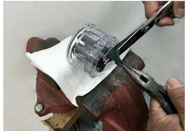
Slika 29 Demontaža gnječnog ventila
