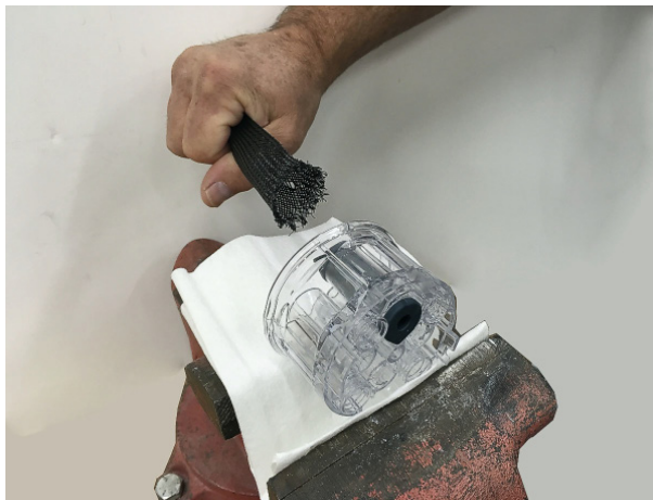
Slika 32 Uvlačenje gnječnog ventila u kućište ventila
