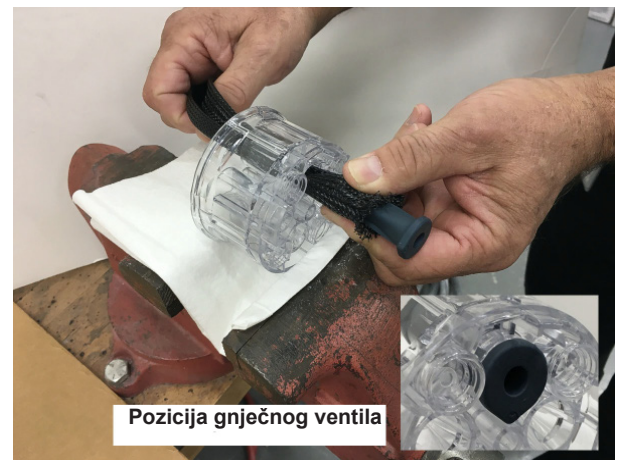
Slika 30 Uvođenje gnječnog ventila u alat za umetanje
