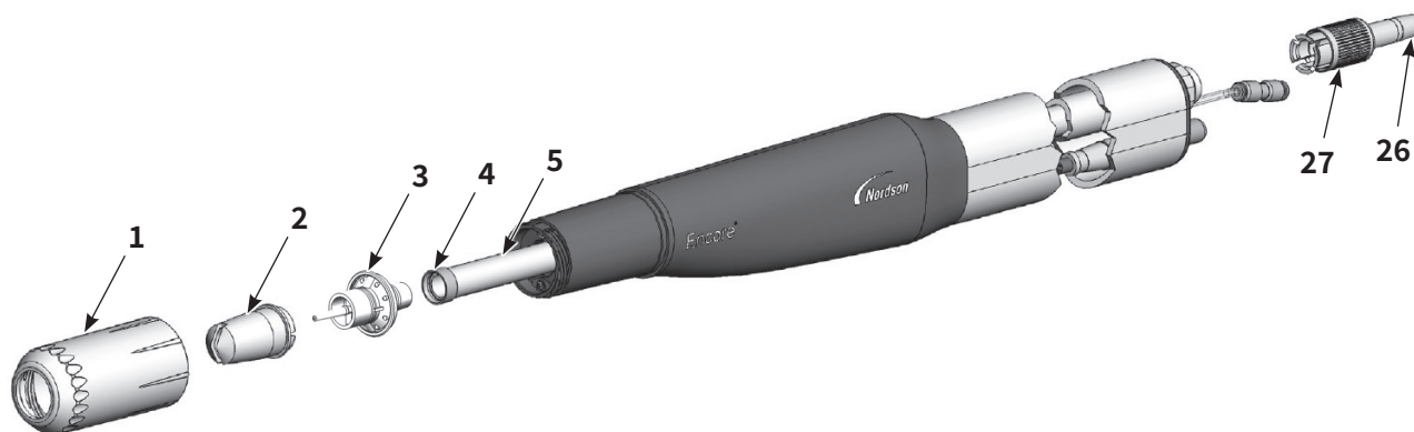
図16 パウダーにより摩耗したパーツの交換
