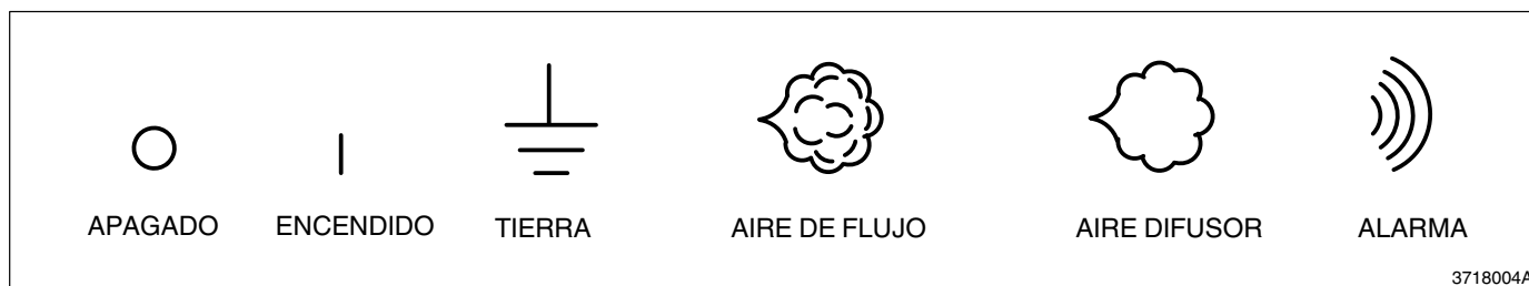
Fig. 2-4 Símbolos utilizados en la unidad de control
