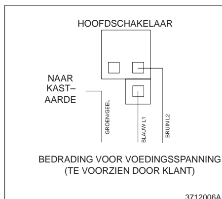
Afb. 3-2 Aansluitingen voor voedingsspanning
