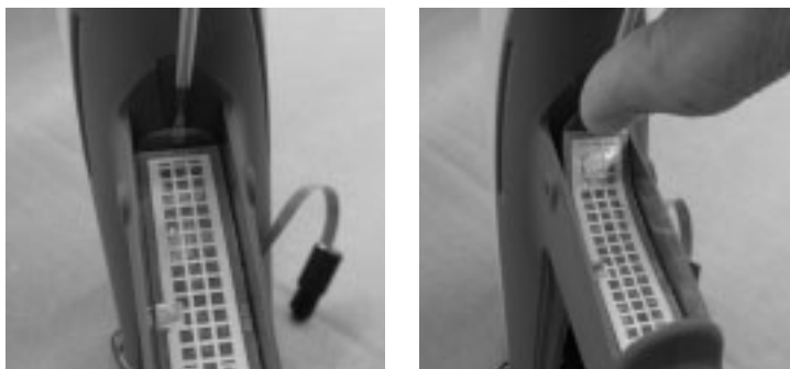
Figura 18 Scoaterea comutatorului de declanșare din mâner
