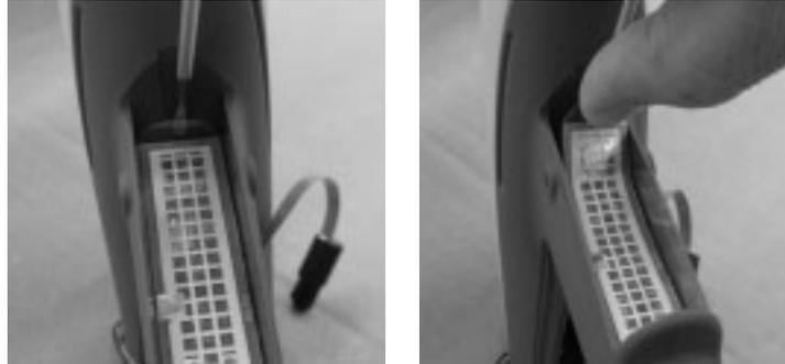
図 18 ハンドルからのトリガースイッチの取り外し
