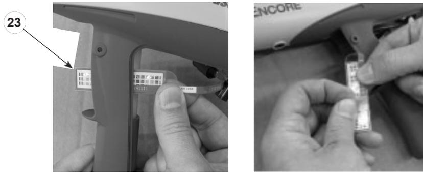
図 19 トリガースwitchの取り付け- ステップ 1 と 2
