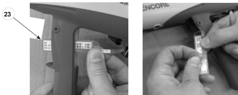
Figura 19 Installazione dell'interruttore di attivazione- Passi 1 e 2
