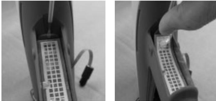
Figura 18 Rimozione dell'interruttore a grilletto dall'impugnatura
