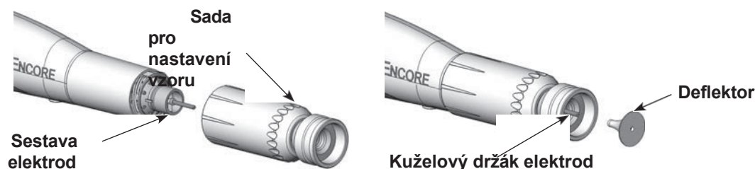
Obrázek 8 Instalace sady pro nastavení vzoru
