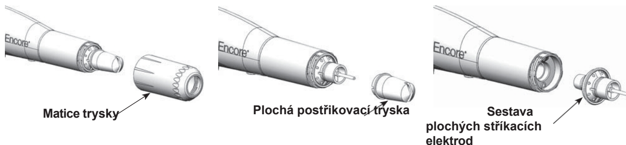
Obrázek 6 Výměna ploché stříkací trysky
