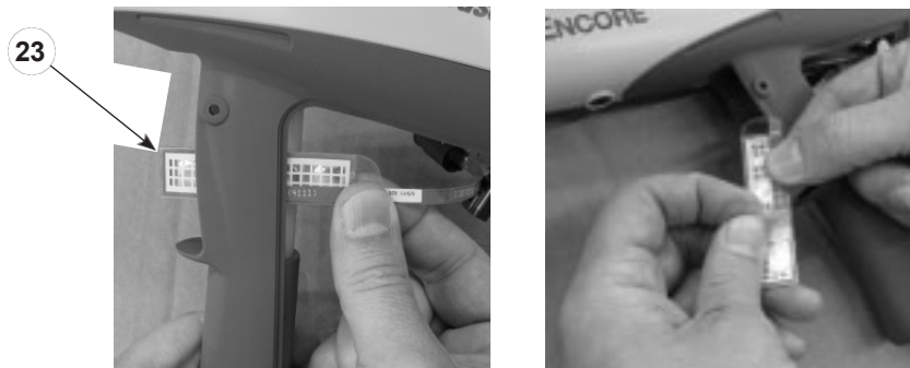
Obrázek 19 Instalace spouštěcího spínače– Kroky 1 a 2
