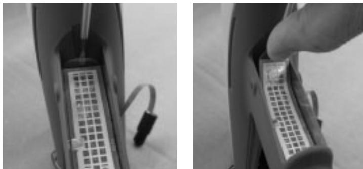
Obrázek 18 Demontáž spouštěcího spínače z rukojeti
