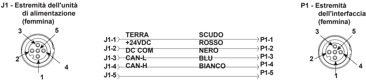
Figura 6-2 Cablaggio del cavo di interconnessione del controllore
