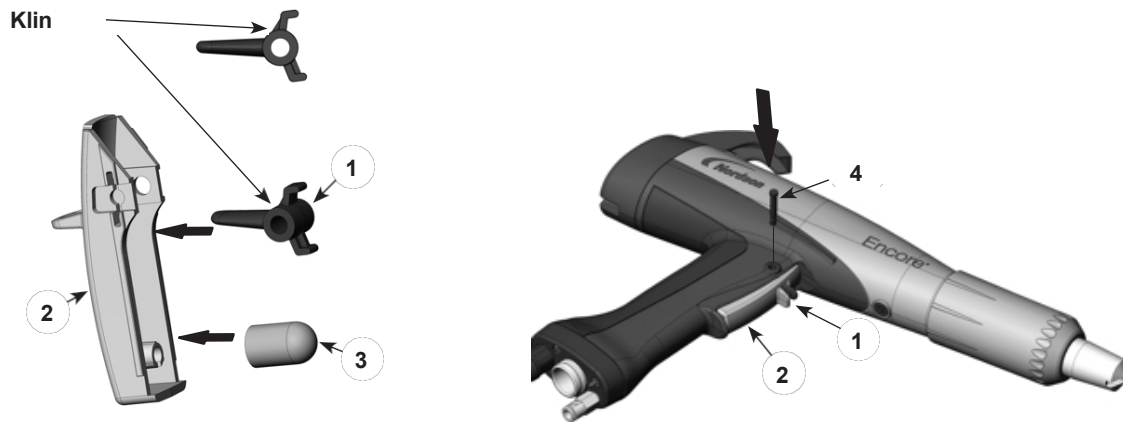
Rysunek 6-13 Ponowna instalacja spustu i osi
