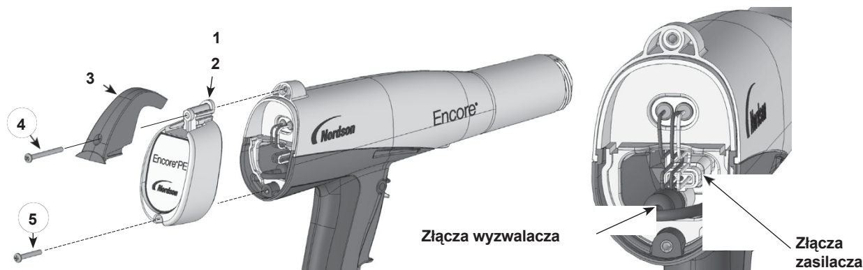
Rysunek 6-1 Demontaż pistoletu
