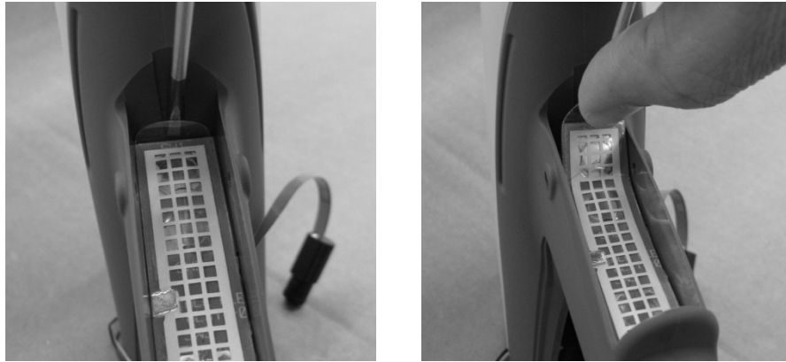
Ilustracja 6-9 Zdejmowanie przełącznika spustowego z uchwytu
