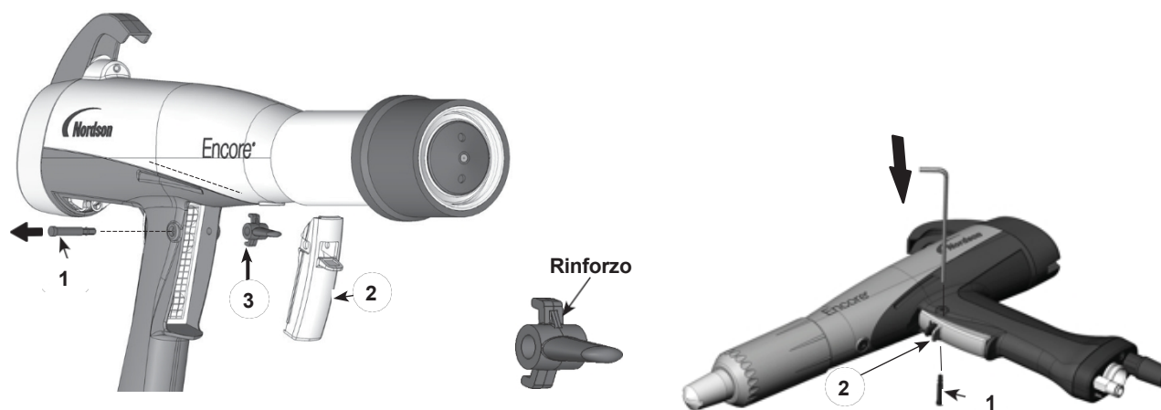
Figura 6-8 Rimozione dell'asse e del grilletto dalla maniglia
