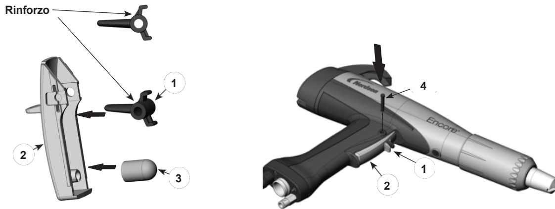
Figura 6-13 Reinstallazione dell' I grilletto e sull'asse
