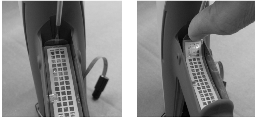
Figura 6-9 Rimozione dell' l'interruttore a grilletto dall'impugnatura
