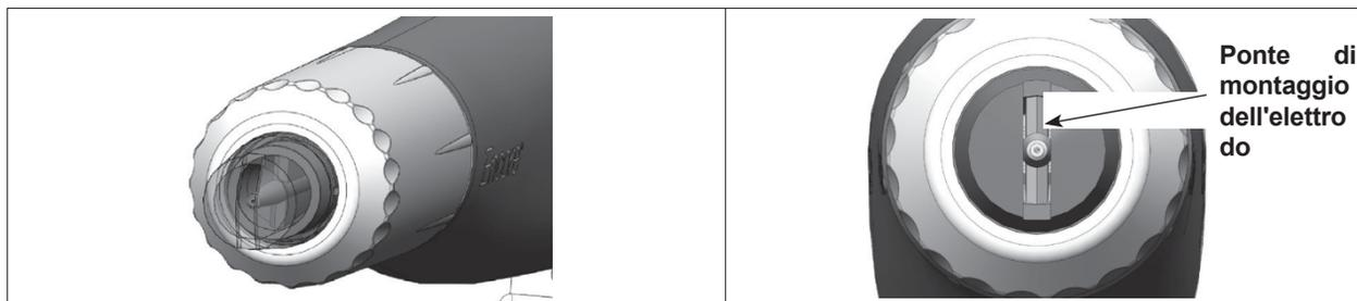
Figura 6 Orientamento corretto dell'ugello
