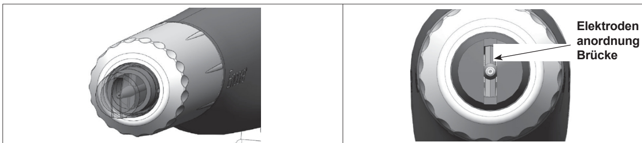
Abbildung 6 Korrekte Ausrichtung der Düse
