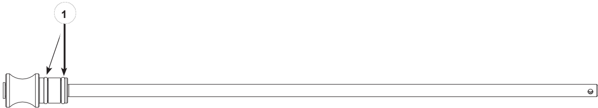
图 9 NHR-8-50 取样管和泵适配器
