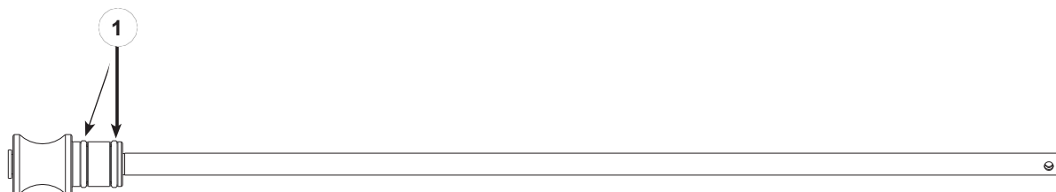
Figura 9 Tub de colectare NHR-8-50 și adaptor pentru pompă
