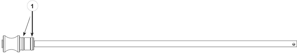
Abbildung 9 NHR-8-50 Aufnahmerohr und Pumpenadapter
