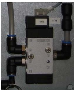
**Exécution avec électrovanne :** En position de repos, la vanne proportionnelle est contournée (mode manuel).
