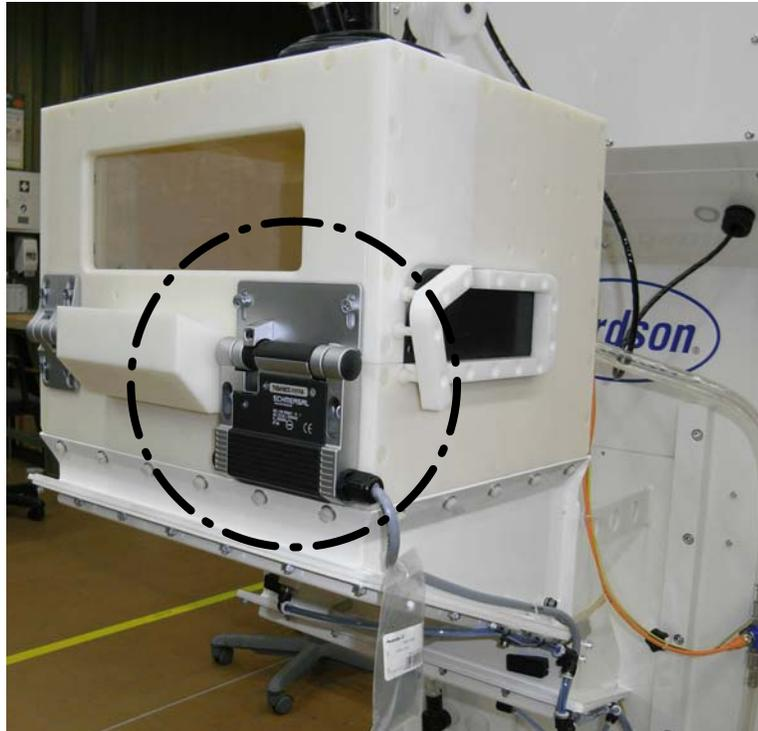
Fig. 10-3 Exemple de chambre de pulvérisation avec contact de sécurité
