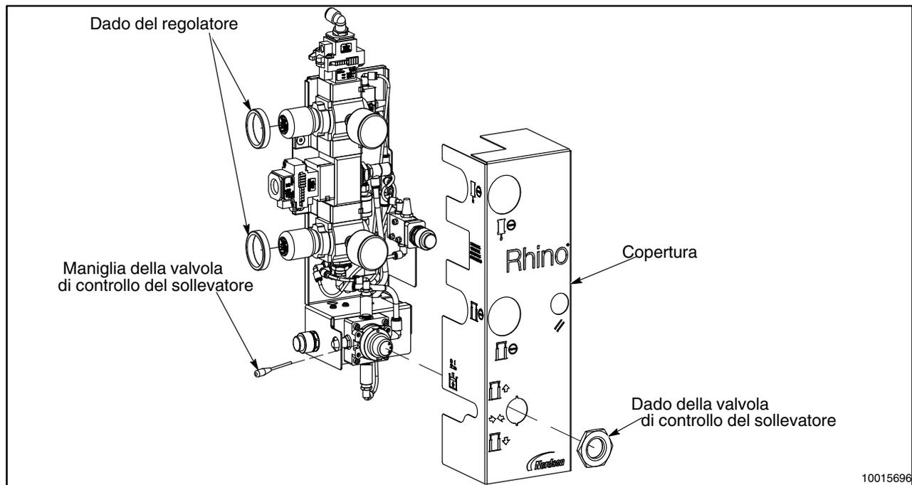
Figura 1 Rimozione della copertura del modulo di controllo pneumatico
