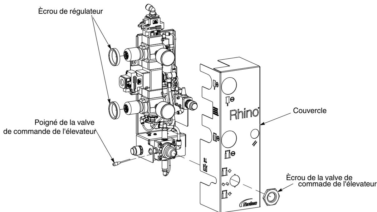
Figure 1 Dépose du capot du module de commande pneumatique
