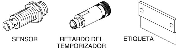
Figura 1 Conjunto del sensor típico para detectar reacciones incontroladas
