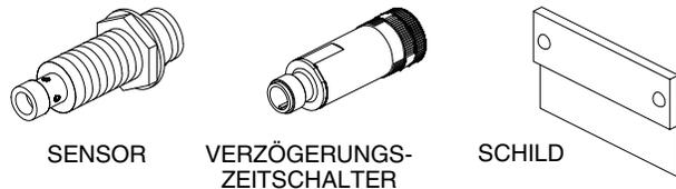
Abb. 1 Typische Baugruppe Ausreißen-Sensor
