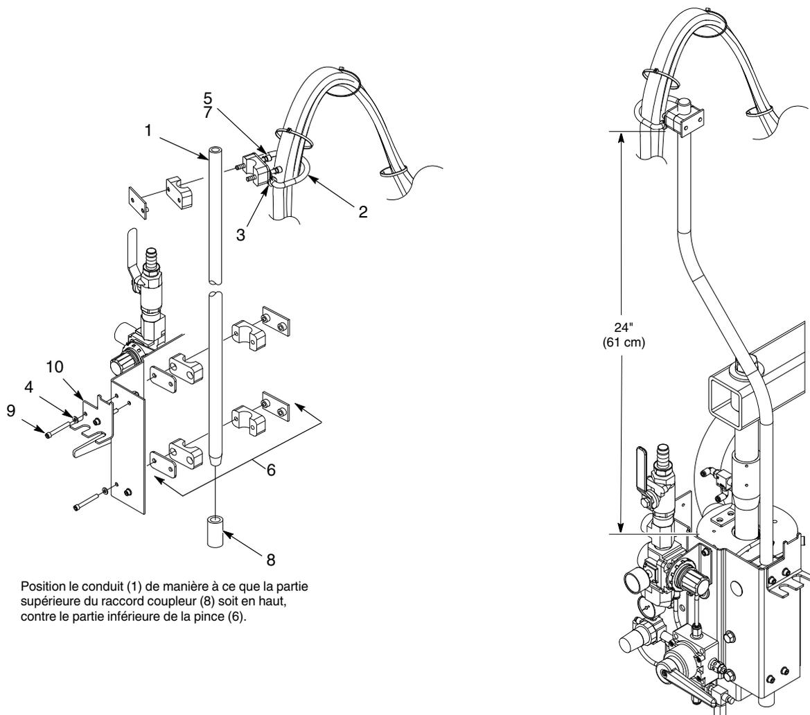
Position le conduit (1) de manière à ce que la partie supérieure du raccord coupleur (8) soit en haut, contre le partie inférieure de la pince (6).
