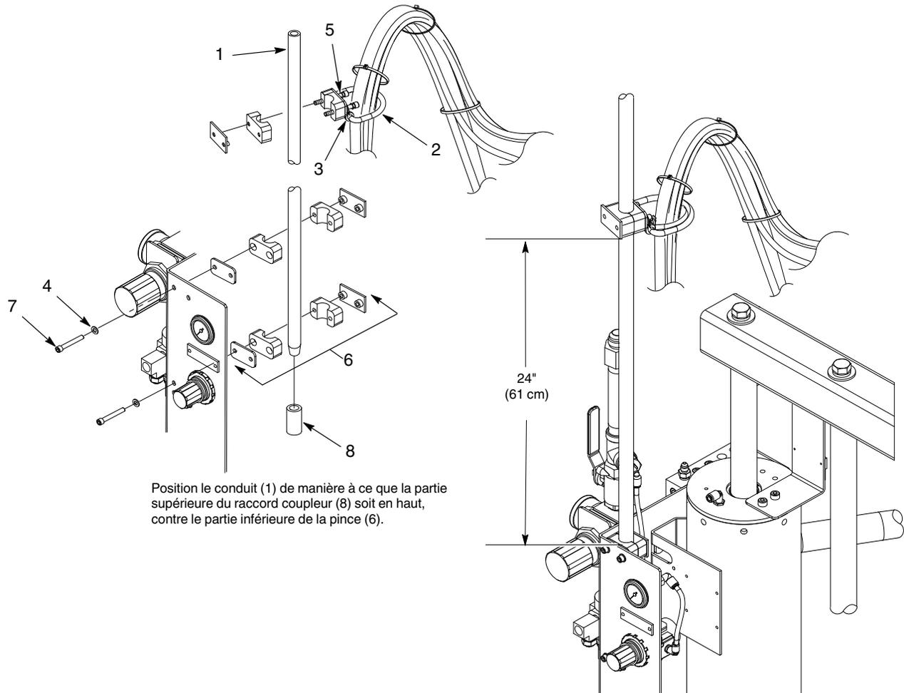
Position le conduit (1) de manière à ce que la partie supérieure du raccord coupleur (8) soit en haut, contre la partie inférieure de la pince (6).
