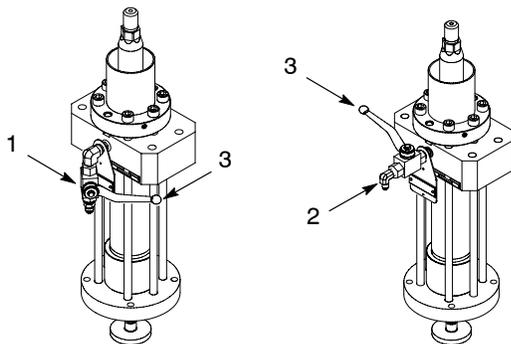
Abb.1 Typische Kugelhahn-Ablassventile
