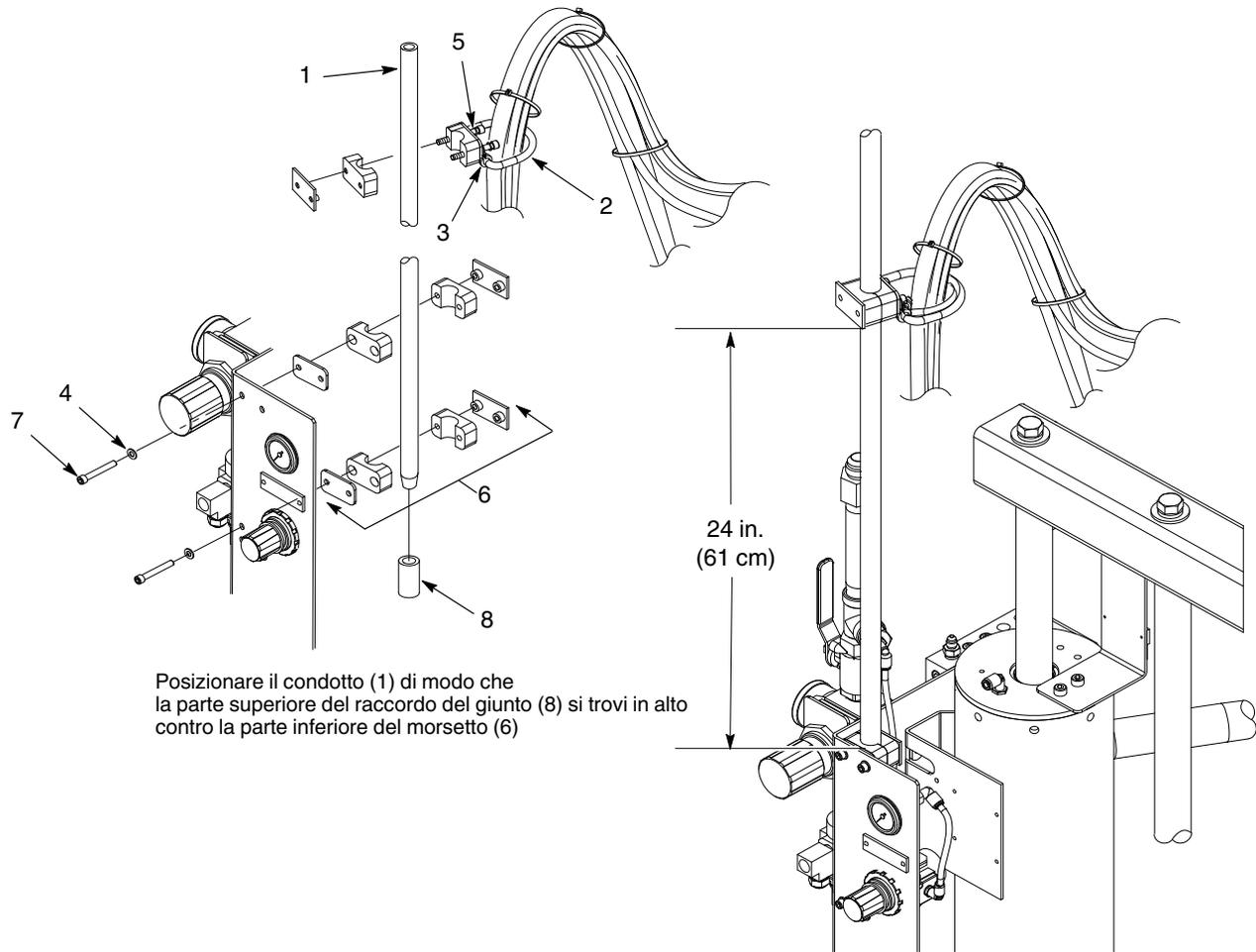
Figura 1 Tipica installazione di Rhino SD2/XD2
