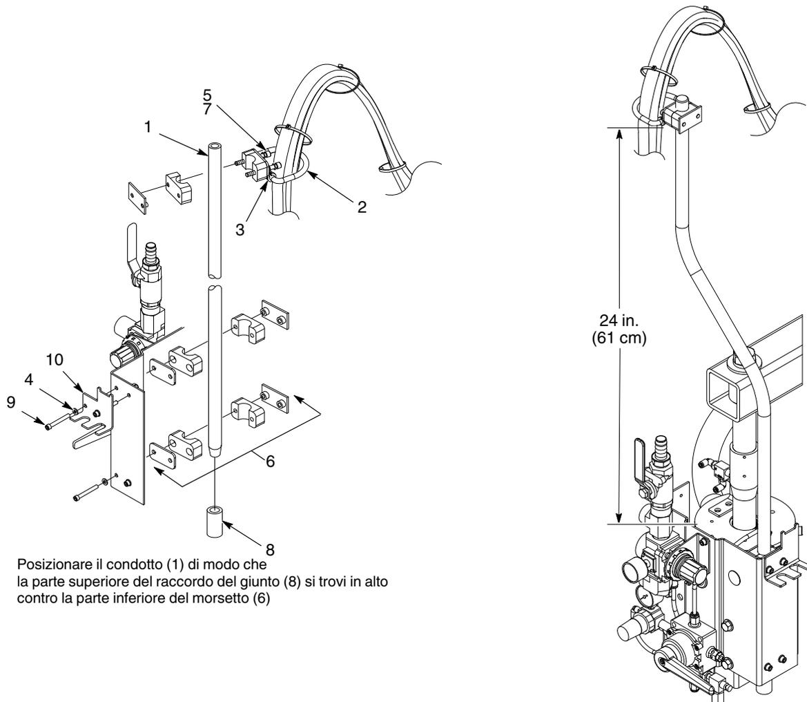
Posizionare il condotto (1) di modo che la parte superiore del raccordo del giunto (8) si trovi in alto contro la parte inferiore del morsetto (6)
