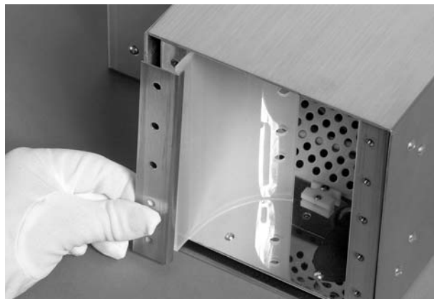
Rysunek 4-7 Wkładanie wspornika mocującego odbłyśnik skupiający
