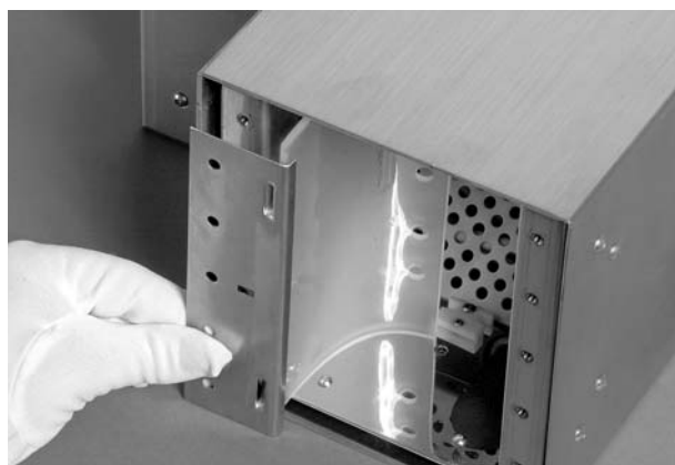
Rysunek 4-9 Wkładanie wspornika mocującego odbłyśnik światła rozproszonego
