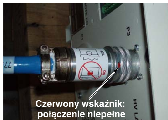
Rysunek 3-5 Złącze niedokręcone do oporu
