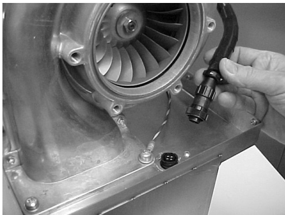
Abb. 5-10 Gebläsestecker und Schrauben abnehmen
