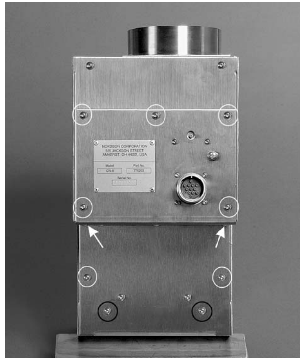
Fig. 4-10 Dépose du capot du logement de lampe
