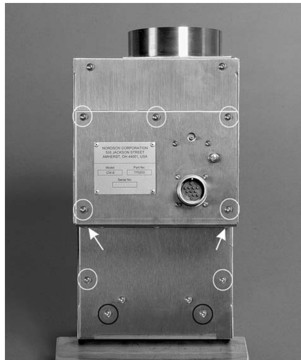
Fig. 4-10 Smontaggio del pannello del gruppo lampada
